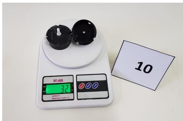
FIGURA 16 - COMPONENTE 10) TAMPA LATERAL DO ROLO MAIOR
