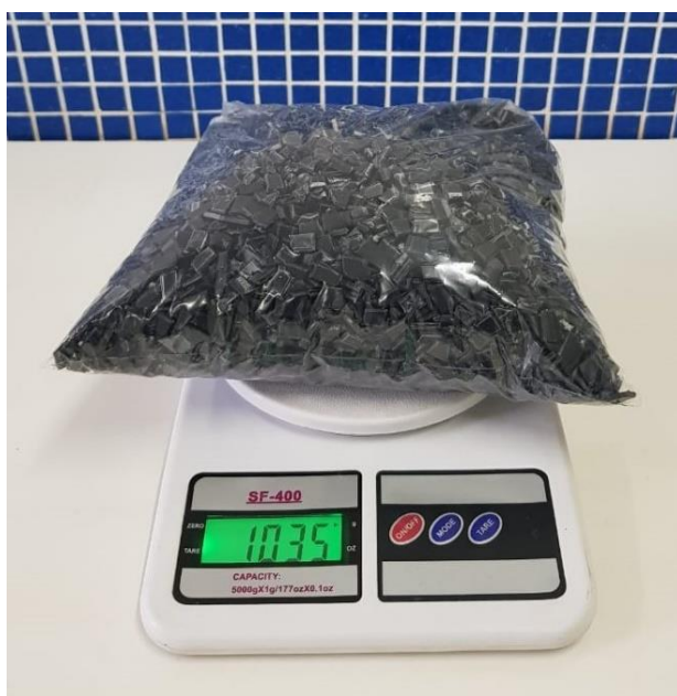
FIGURA 29 - FRAGMENTOS DOS COMPONENTES FEITOS EM ABS RECICLADO
