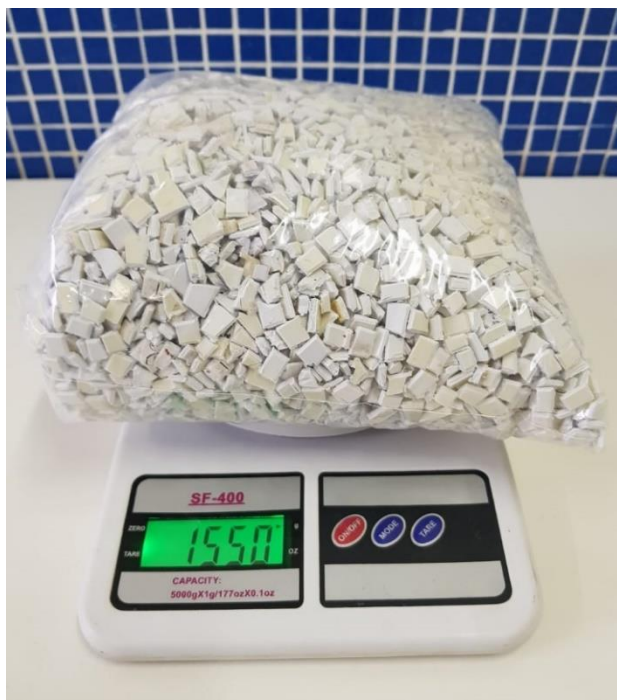
FIGURA 28 - FRAGMENTOS DOS COMPONENTES FEITOS EM ABS VIRGEM
