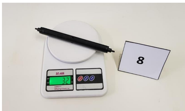
FIGURA 14 - COMPONENTE 8) ROLO MENOR INTERNO
