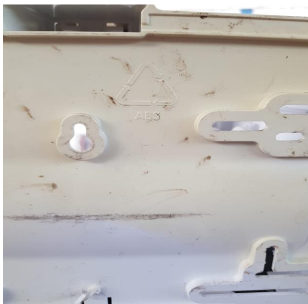
FIGURA 5 - SÍMBOLO DE CLASSIFICAÇÃO DO POLÍMERO TERMOPLÁSTICO (ABS)
