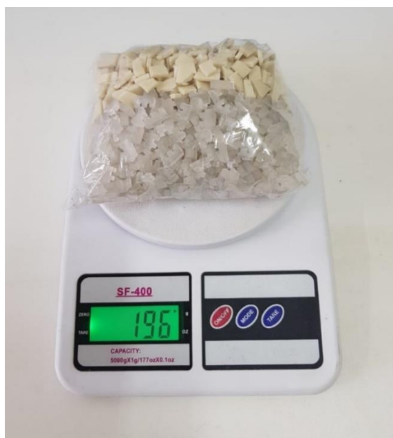
FIGURA 31 - FRAGMENTOS DOS COMPONENTES FEITOS EM SILICONE VIRGEM
