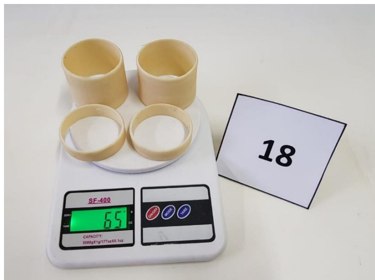
FIGURA 24 - COMPONENTE 18) BORRACHA DO ROLO MAIOR
