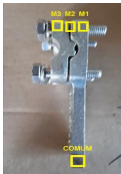
FIGURA 12 - PONTOS USADOS PARA MEDIÇÃO DAS RESISTÊNCIAS ELÉTRICAS
