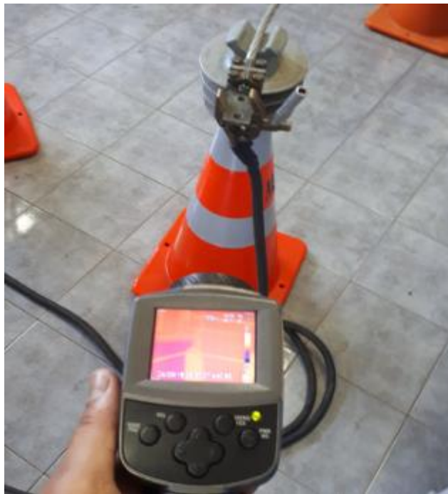
FIGURA 24 - MEDIÇÃO DA TEMPERATURA COM O TERMOVISOR SEM CONTATO
