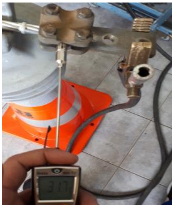
FIGURA 23 - MEDIÇÃO DA TEMPERATURA COM O TERMOPAR DE CONTATO
