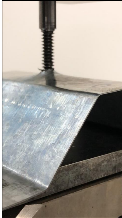
FIGURA 4.2 – Processo de falha da terço durante o ensaio de pull-out
