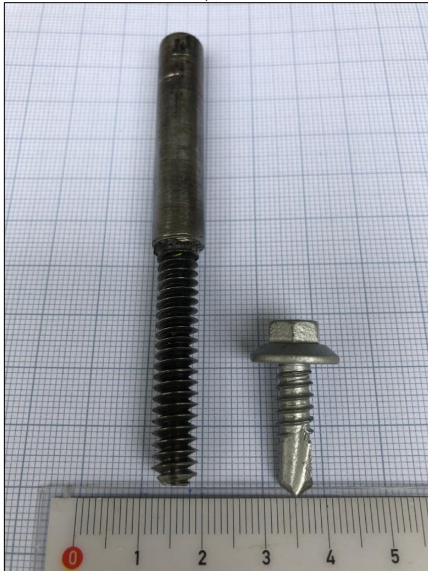
FIGURA 3.6 – Protótipo da rosca do parafuso proposto e do parafuso comercial utilizados no ensaio de pull-out
