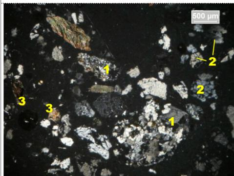
Fotomicrografia: fragmentos de rocha quartzosa (1), grãos de quartzo com extinção ondulante (2) e xisto (3). Imagem com luz transmitida polarizada.
